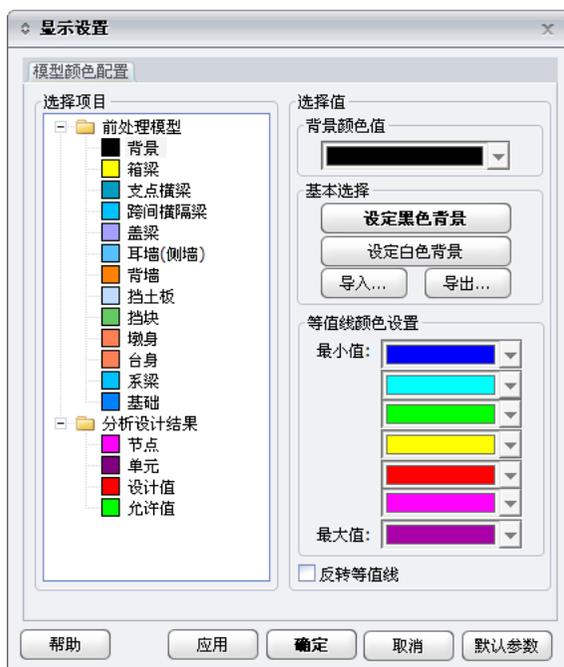
显示设置功能可以设置前处理模型及分析设计结果图形中的各部件或元素颜色显示效果，可满足用户不同的显示需求。
