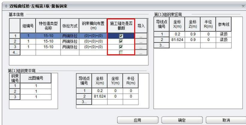
图 3.3.1-1 分阶段浇筑-腹板钢束-导线方式
