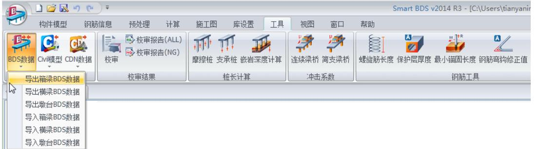
**要点1:** 箱梁构件结构类型及跨数相等时方可导入；横梁结构类型相同时方可导入；下部结构类型相同时方可导入。
