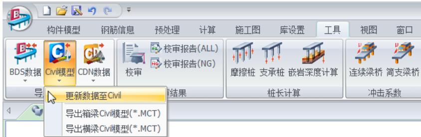
**要点1:** 构件执行【预处理】后，可导出.mct 格式数据文件。打开 Civil 程序，新建 Civil 模型，导入此“.mct”文件。（支持满堂浇筑等高连续箱梁正直桥、正弯桥及其横梁；支持悬臂浇筑及满堂浇筑变高连续箱梁导出.mct 数据文件）。
