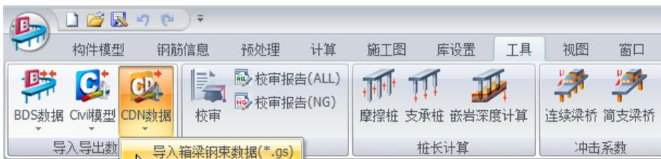
**要点1:** BDS 建立模型，导入 Civil 中进行分析，分析后一键启动 CDN 进行设计。设计中调束以后可以同步更新到 BDS 中，也可以导出箱梁钢筋数据。
