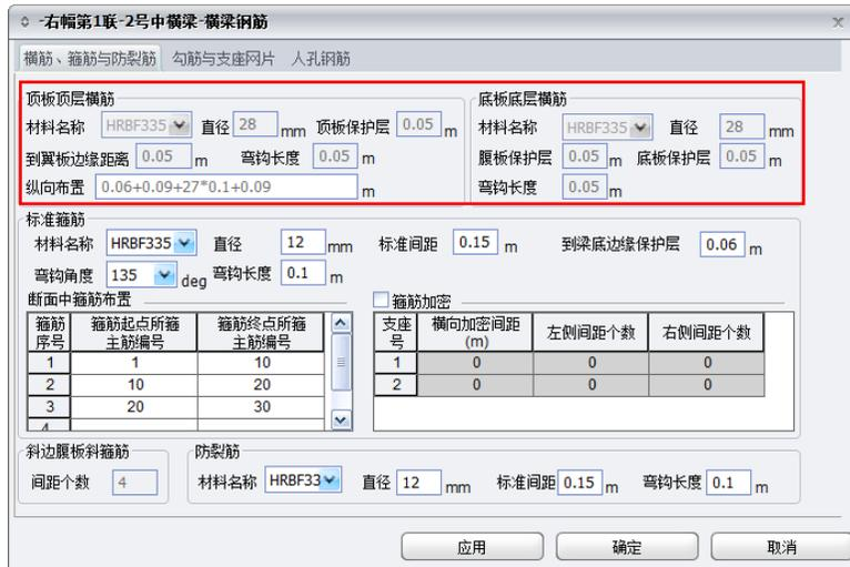
图 2.3.5.3-2 中横梁-横梁钢筋 (不设置骨架)
