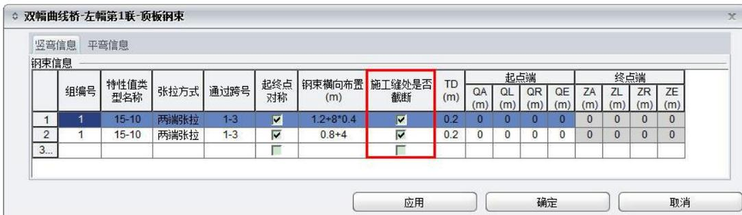
图 3.3.2-2 顶板钢束-参数方式-竖弯
