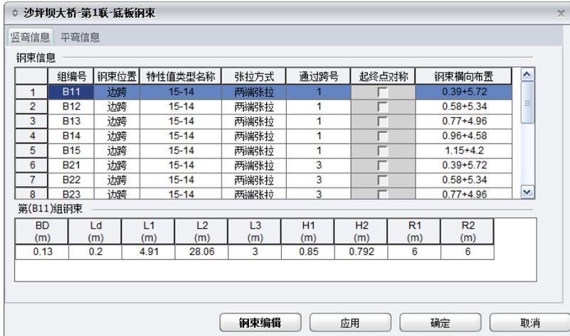
图 2.2.2.3-2 底板钢束-参数方式-竖弯
