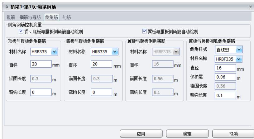
图 2.2.3-3 箱梁钢筋-倒角筋
