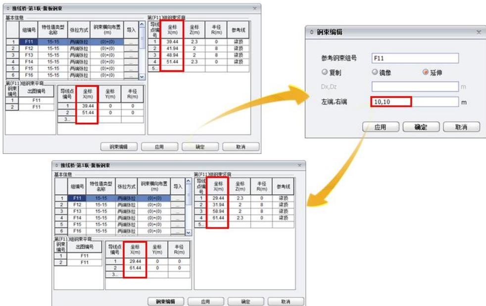
图 2.2.2.1-6 导线方式-钢束编辑-延伸功能
