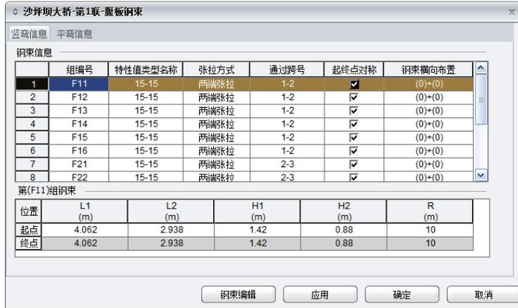
图 2.2.2.1-7 腹板钢束-参数方式-竖弯
