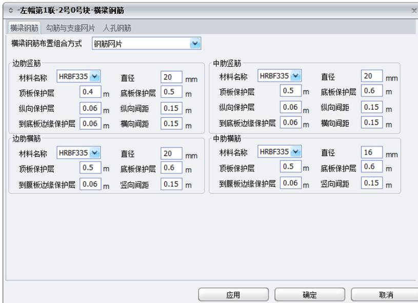
图 2.2.5.2-2 0号块-横梁钢筋 (1~3 箱室、钢筋网片)
