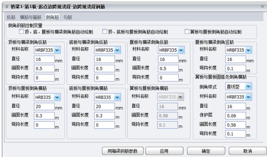
图 2.2.4.2-4 边跨现浇段钢筋-倒角筋
