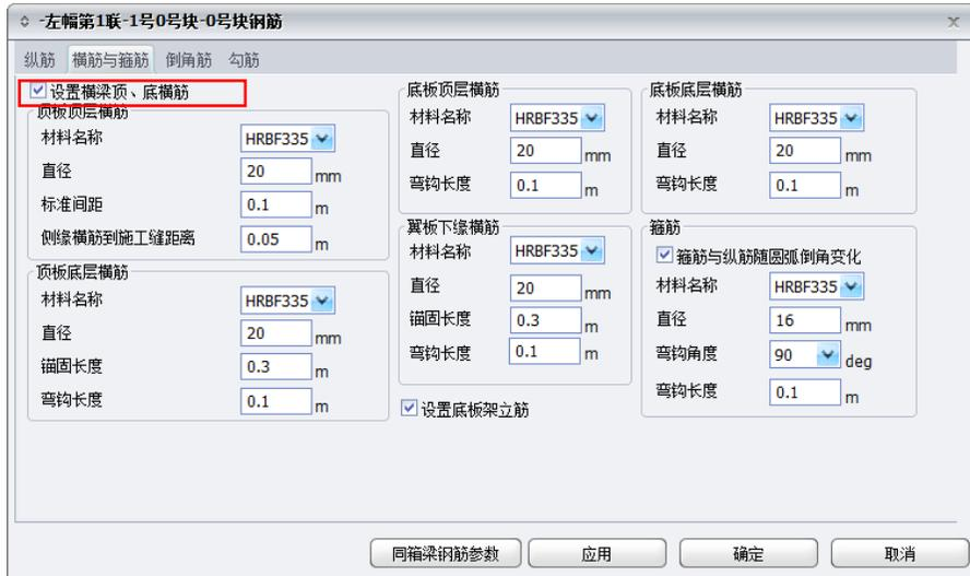
图 2.2.5.3-4 0 号块钢筋-横筋与箍筋
