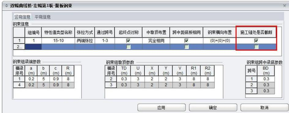
图 3.3.1-2 分阶段浇筑-腹板钢束-参数方式-竖弯信息
