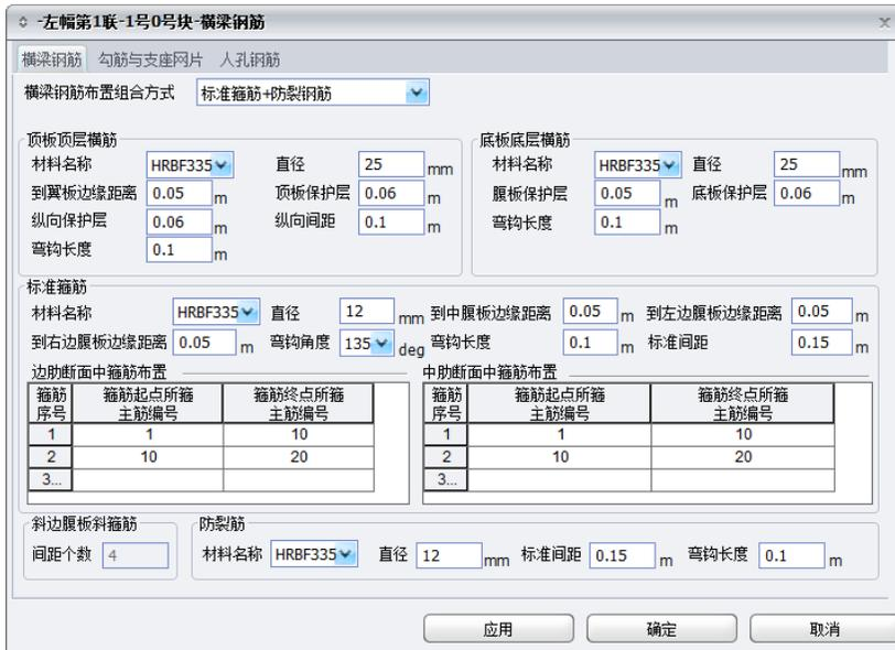
图 2.2.5.2-1 0号块-横梁钢筋 (1~3 箱室、箍筋+防裂筋)
