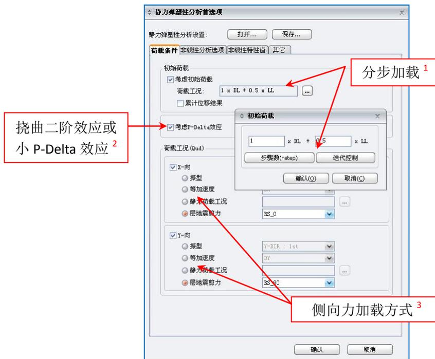
图 1.21.20 静力弹塑性荷载施加
